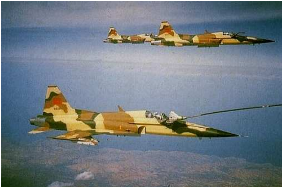
F5 en ravitaillement grâce au probe installé par AMIN
