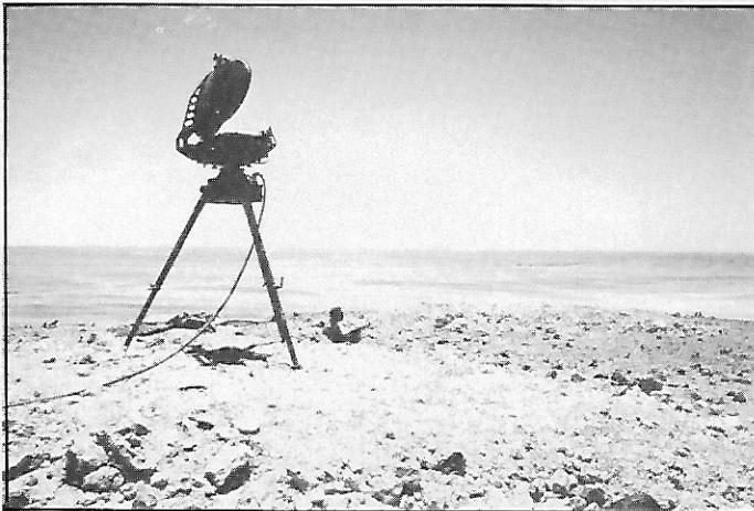
Sur le Mur, au Sahara occidental, guetteur des FAR et radar RASIT LMT (France) de détection terrestre de portée 15 km sur piéton, 15 à 25 km sur avion léger ou hélicoptère, 30 km sur véhicule
