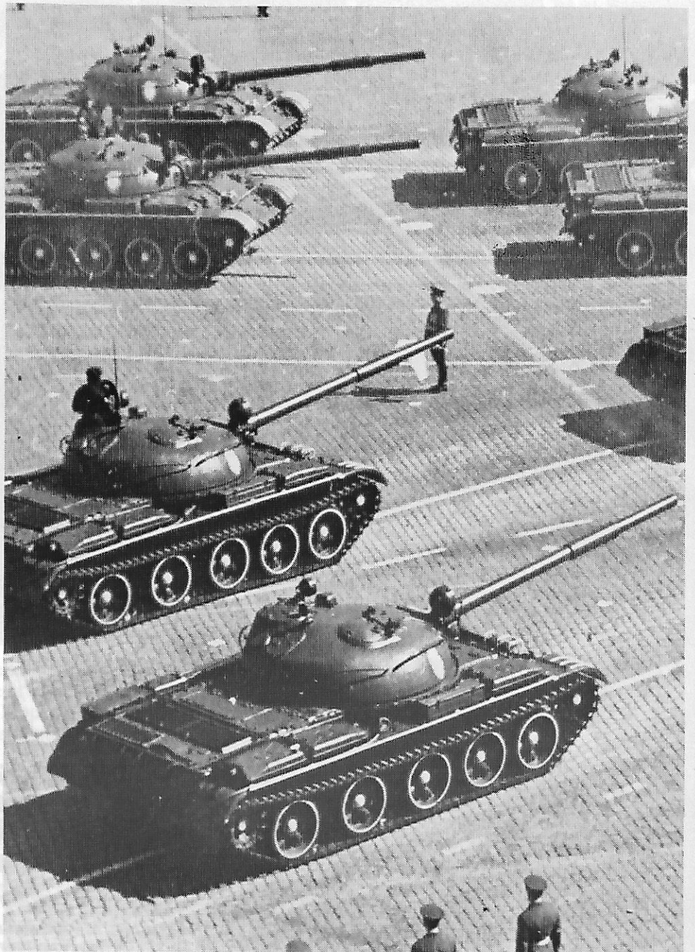
Le T.62 a été le premier char au monde à être armé d'un canon à âme lisse.
